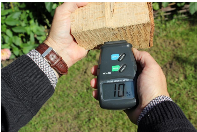
BU: Digitales Messgerät zur Bestimmung der Holzfeuchte (Foto: KOLLAXO)
