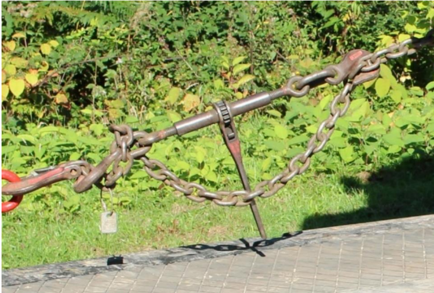
Foto 2 (Ratschlastspanner im Einsatz)
